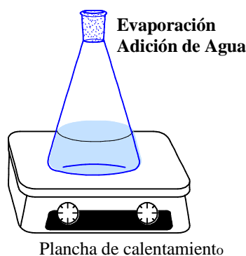
Figura N1. Matraz erlenmeyer que contiene solución de NaCl (0,1g/mL) de la cual, paulatinamente se evapora agua por calentamiento.
